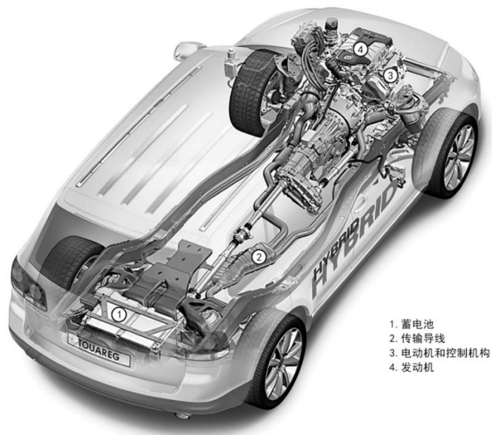
图 2 混合动力电动汽车结构图
