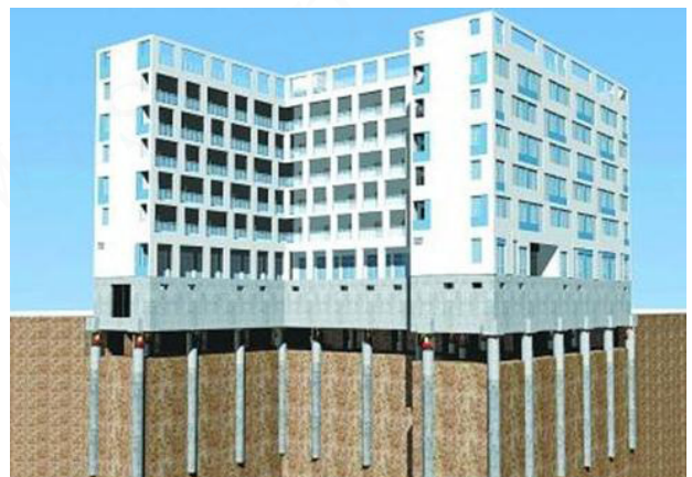
图 59 预筑落成法示意
