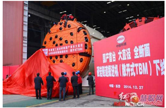
图 60 中国首台大直径全断面硬岩隧道掘进机 图片来源：慧聪工程机械网
